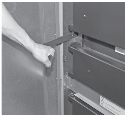
Fig. 40 Hebel-Heizflächenreinigung 5–10 x betätigen – LogWIN Klassik pellet ready
