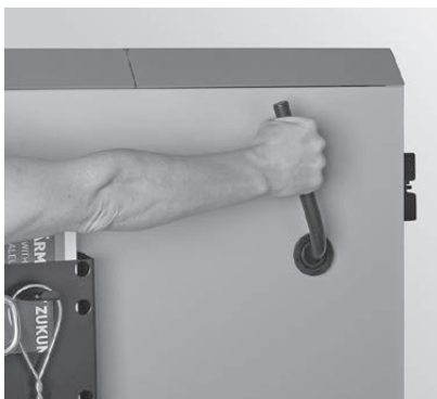
Fig. 39 Hebel-Heizflächenreinigung 5–10 x betätigen – LogWIN Klassik
