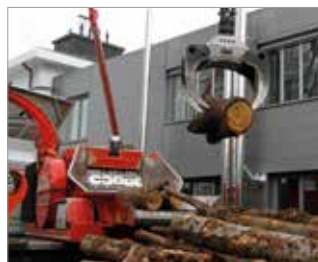
02. Das zwischengelagerte und vorgetrocknete Holz wird gehackt
