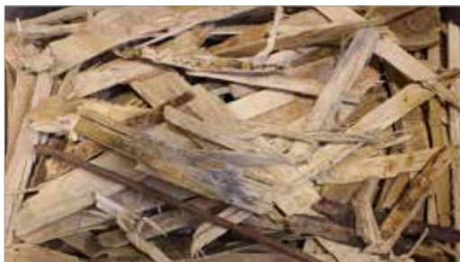
Geschreddertes Holz, nur lange Teile, keine glatten Schnittkanten
