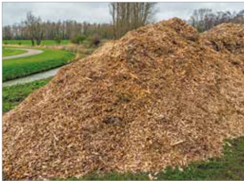
Ein ungleichmäßiger Wassergehalt des Hackholzes oder Regen können zu sogenannten Feuchtenestern führen
