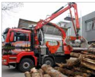
01. Ein mobiler Hacker ist zum Hacken direkt beim Verbraucher vor Ort
